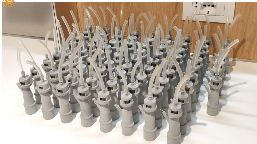
LA FABRICATION ADDITIVE A PERMIS DE FABRIQUER TRÈS RAPIDEMENT DES PIÈCES TECHNIQUES COMME CES VALVES INDISPENSABLES AU FONCTIONNEMENT DES RESPIRATEURS ARTIFICIELS.
